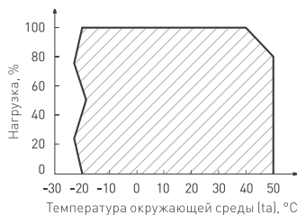
Рис. 3. Максимальная допустимая нагрузка, % от мощности источника
